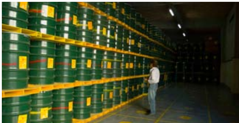
Embalagens metálicas com resíduos radioativos
